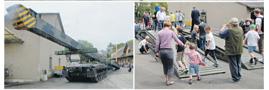
Der Brückenpanzer 68/88 in Aktion: Innerhalb weniger Minuten ist die Brückenkonstruktion ausgelegt. Die Besucher nutzen gerne die Gelegenheit, diese zu überschreiten. Bilder: Daniel Thüler
