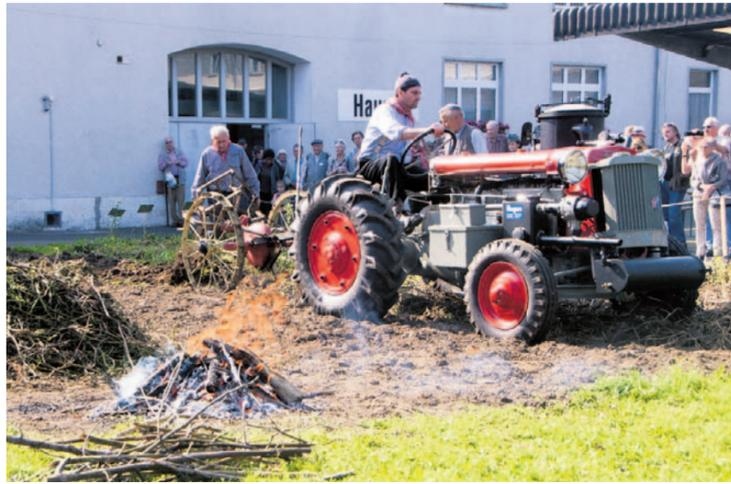
Oft wurden in der «Anbauschlacht» Traktoren mit Holzvergaser eingesetzt, da fossile Brennstoffe während des Zweiten Weltkriegs Mangelware waren.
